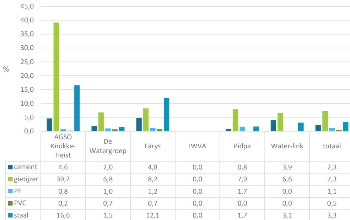
Figuur 13 Aandeel toevoer- en distributieleidingen ouder dan de technische levensduur per materiaal per waterbedrijf (2019)
