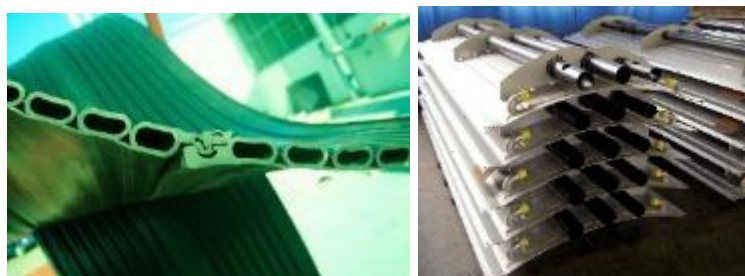
Figuur 13 – warmtewisselaar voor inbouw in bestaande riolering (Brandenburger Liner en EAWAG)
