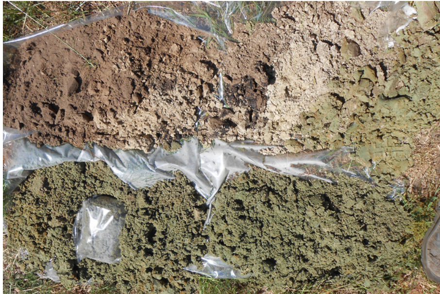
Figuur: Op plasticfolie uitgespreid materiaal, per meter, van links naar rechts; de positie van het boorgat is onderaan de foto (buiten beeld).
