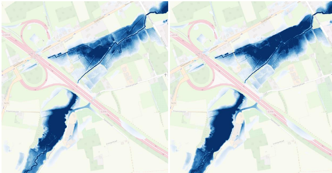
Figuur 36: Toename van overstromingsdieptes opwaarts van twee duikers in de Begijnebeek nabij Assen bij een T20-bui in huidig klimaat (links) en een T20-bui in het hoogzomer-scenario 2050 (rechts)
