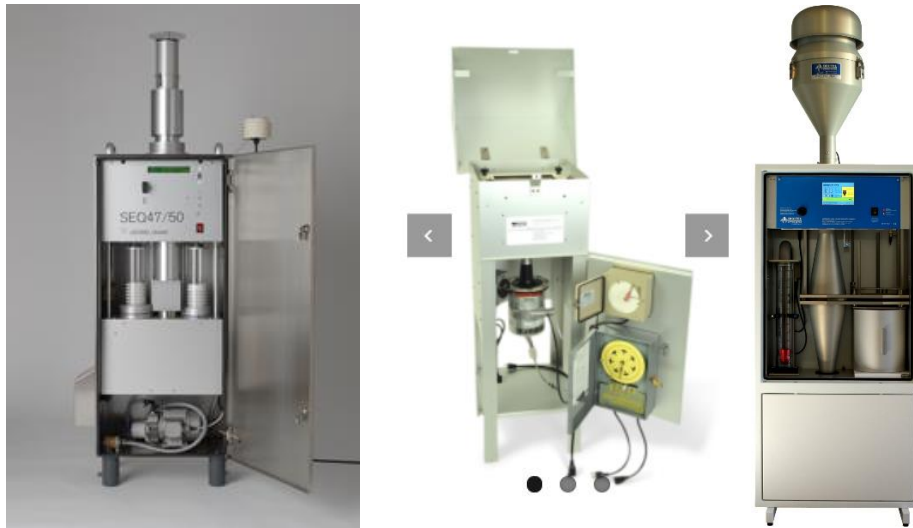
Figuur 1: Foto van de filterbemonsteraars: lage-volume (links), medium-volume (midden) en hoge-volume (rechts).
